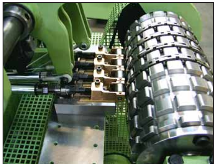
Mustergetriebe mit Musterketten pattern drive with pattern chain
