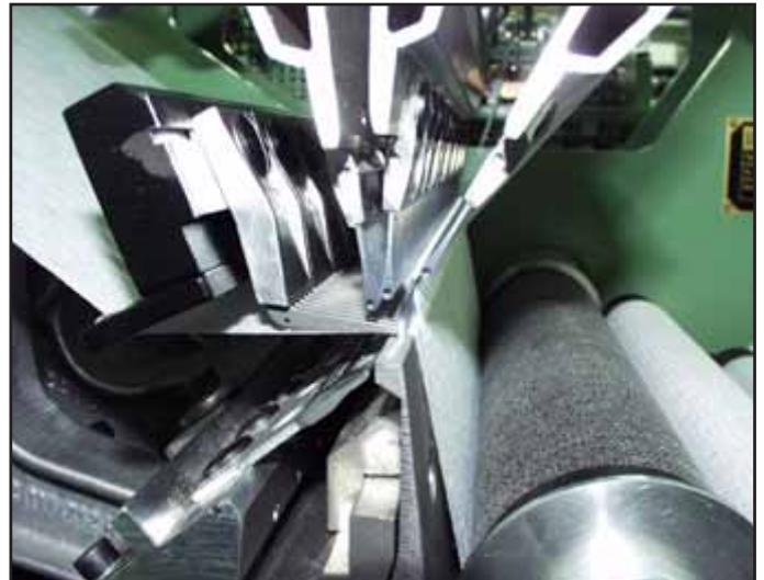
Wirkelemente Racop TR 4-V knitting elements Racop TR 4-V
