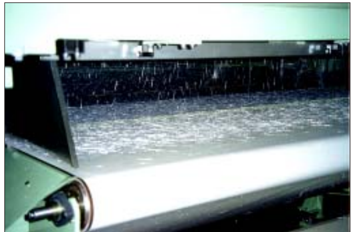
Die Faserschnitzel fallen auf ein Transportband und werden den Wirkelementen zugeführt. Transportbandgestell verfahrbar. The chopped fibers fall onto a conveyor and are transported to the knitting elements. Conveyor belt frame moveable.
