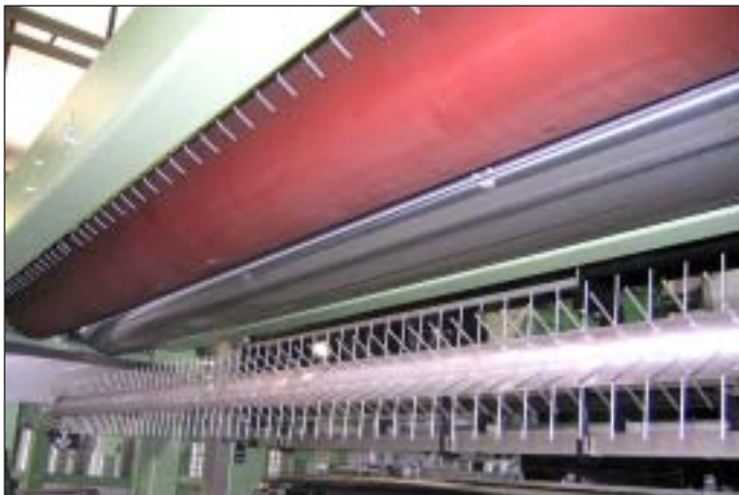
Schneidwalzen der Schnitzeinrichtung. Cutting rollers of the fiber chopper.
