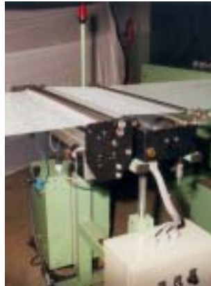
Öleinrichtung Type 10 C zum Auftragen von Präparationsmittel auf die Fadenschar
