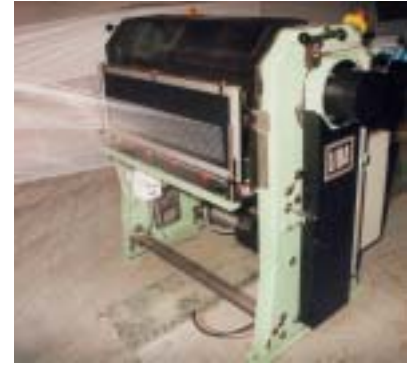
Walzenaggregat WA-4 zur Fadenberuhigung und zum Spannungsausgleich
