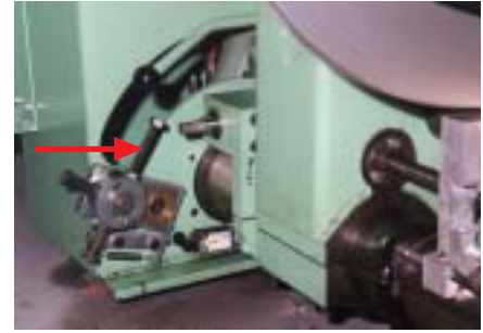
Einstellung des TKB-Flanschdurchmessers durch Anschlag
