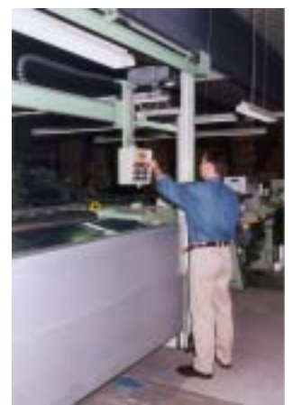
Schutzwand geschlossen bei Schärbetrieb
