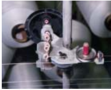
Einzelfadenspanner Tensomat Single yarn brake Tensomat
