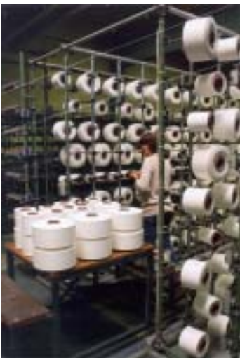
Spulenwagen zur Gatterbestückung Bobbin carriage for creel set-up
