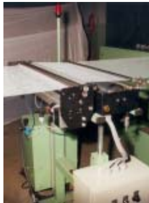
Öleinrichtung Type 10 C zum Auftragen von Präparationsmittel auf die Fadenschar Замасливающее устройство типа 10 C для нанесения замасливателя на свод нитей
