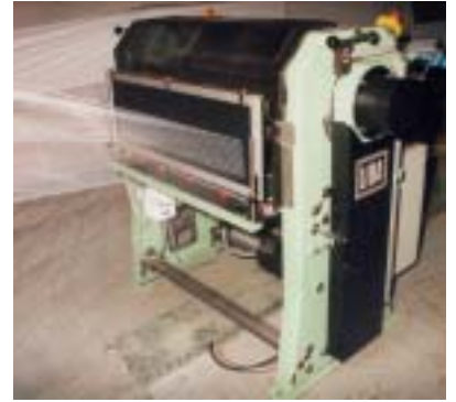
Walzenaggregat WA-4 zur Fadenberuhigung und zum Spannungsausgleich Роликовый агрегат WA-4 для сглаживания нити и выравнивания колебаний натяжения
